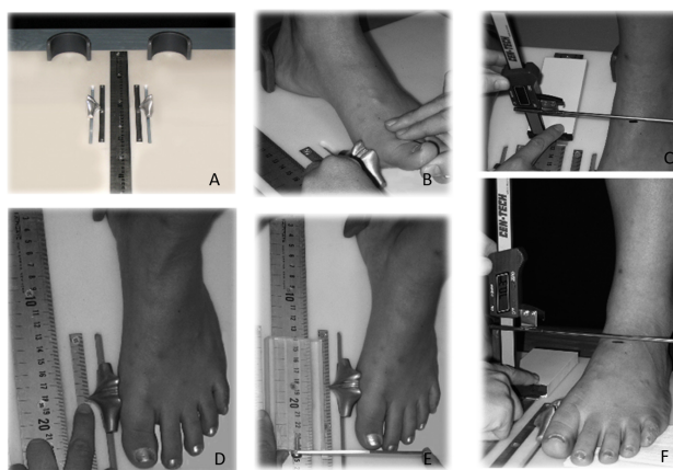
Figura 28. A. Plataforma de medición del pie. B. Maniobra de flexión dorsal del 1. er dedo que indica la correcta posición del indicador de M1. C. Varilla del calibrador vertical sobre la marca del 50% en el dorso. D. Longitud truncada del pie con el indicador de M1. E. Medición de la FL con la barra deslizante. F. Medición del DAH con el calibrador. Tomada de
