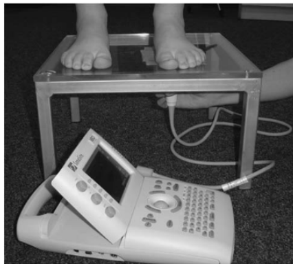
Figura 52. Configuración experimental utilizada para medir el grosor del almohadilla plantar medial del mediopié en carga (161).
