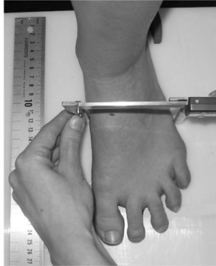
Figura 40. Calibrador digital modificado para medir la anchura del mediopié en carga. Tomada de McPoil et al. (135)
