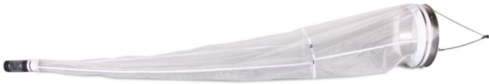
Figura 7: Xarxa d'arrossegament CP3-50 (30cmØx90cmL 300µm CP3- 50 'Aquatic Biotechnology'), per a la recolecció de mostres en superfícies d'aigua i anàlisi de microplàstics.
