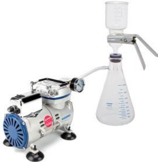
Figura 1: Equip de filtració combinat a una comba de buit.
