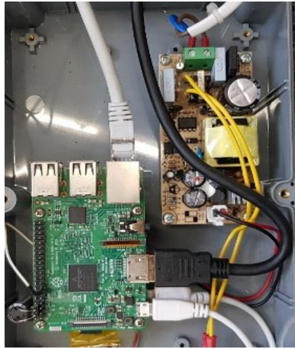
Il·lustració 164 - Sistema d'alimentació i Raspberry pels estudiants del Grau en Multimèdia
