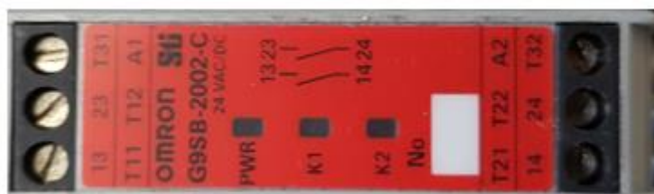
Il·lustració 167 - Centraleta de seguretat
