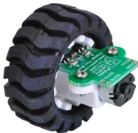
Figura 1: Encoder de roda pel càlcul de l'odometria
