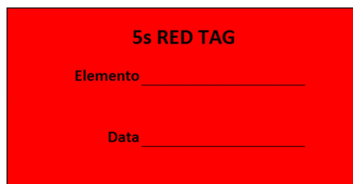
Figura 25. Targeta Red Tag (Font: Utilització a l'empresa)
