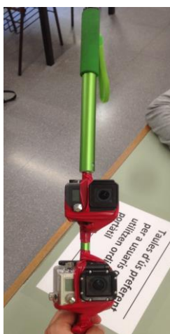
Figura 9: Instrument de gravació format per un pal d'acer inoxidable extensible i 2 càmeres de gravació Go Pro.
