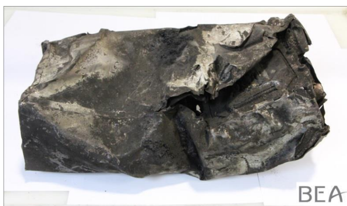
Figura 10. Registrador de datos de vuelo (FDR) – D-AIPX
