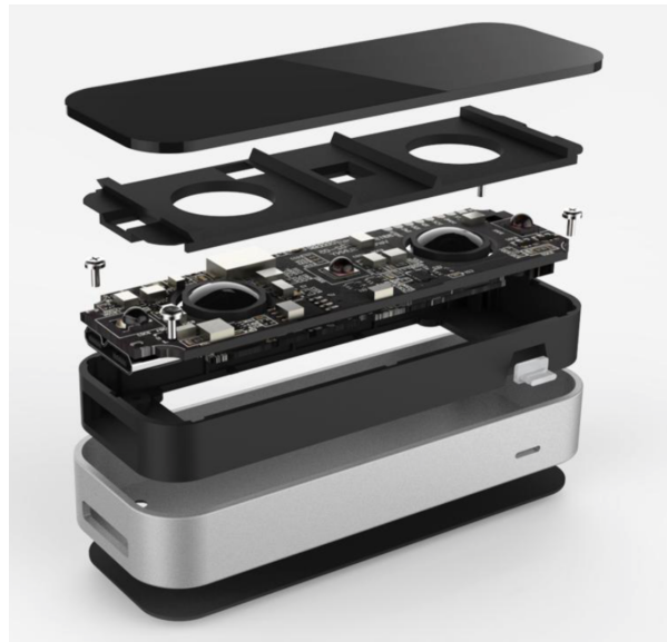
Figura 4.1.2. Disseny intern Leap Motion
