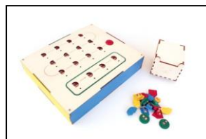
Imatge 3.11.1: Components del robot Primo
