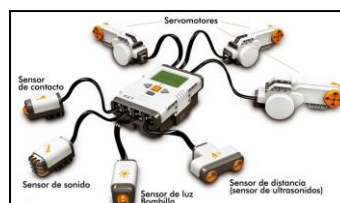
Imatge 3.2.1: Sensors i motors de Legó Mindstorms
