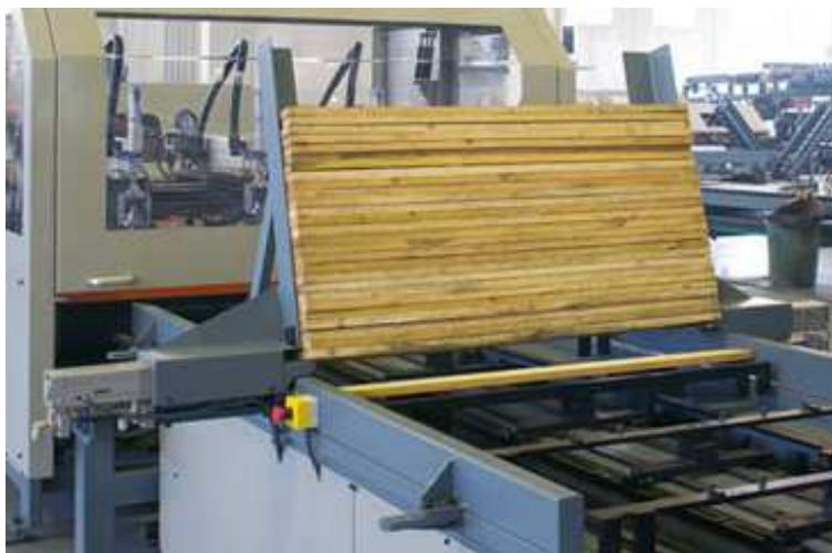
Figura 2.6: Imatge alimentació automàtica de fustes travesseres
