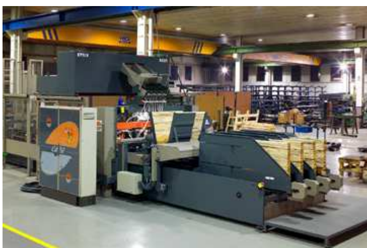
Figura 2.7: Imatge clavadora de parrilles de canvi ràpid
