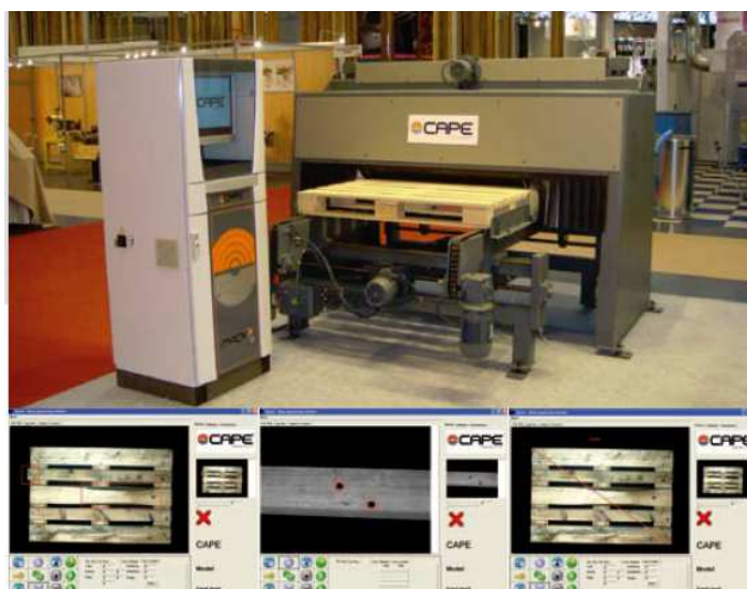
Figura 2.9: Imatge sistema de visió artificial pel control de qualitat.
