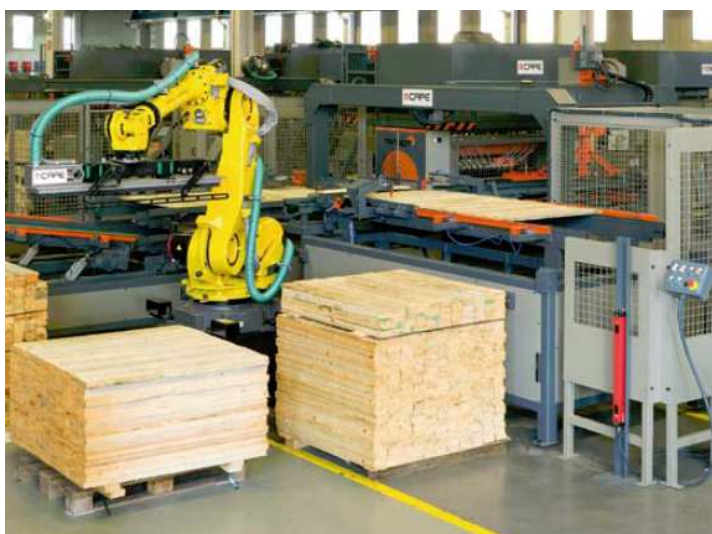
Figura 2.8: Imatge cargador automàtic de fustes superiors amb robot
