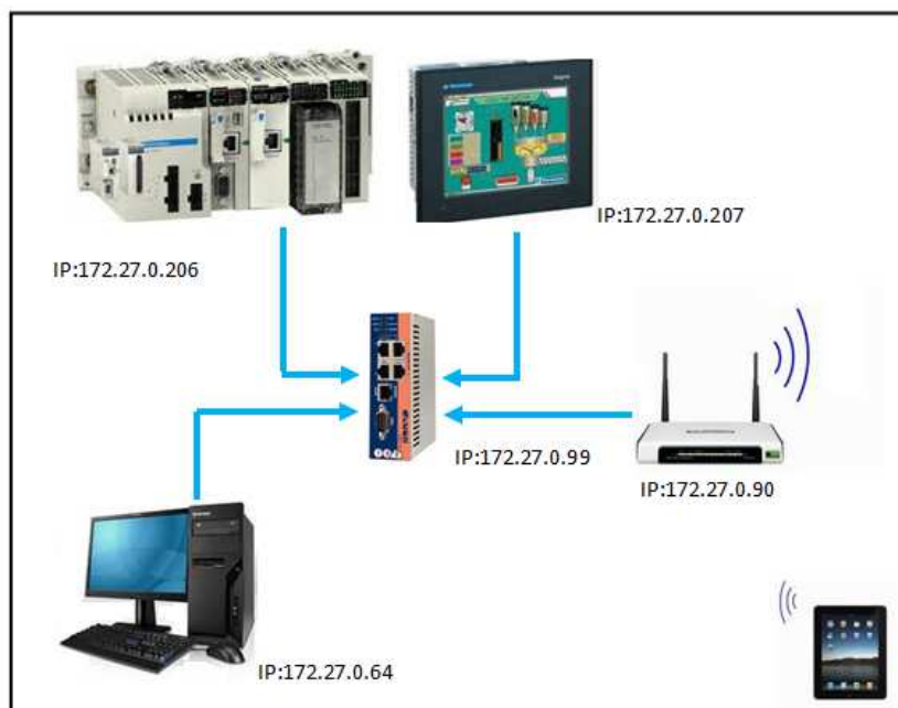
Figura 10.1. Esquema de la integració d'un dispositiu mòbil a la xarxa industrial
