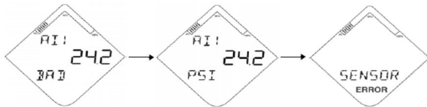
Figura 8.21 Display de visualización local de los transmisores (Rosemount serie 3051S-FF).
