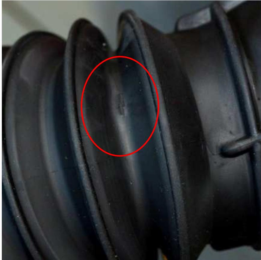
**Fig. 3.3.1.11** Grieta producida en un valle del fuelle
