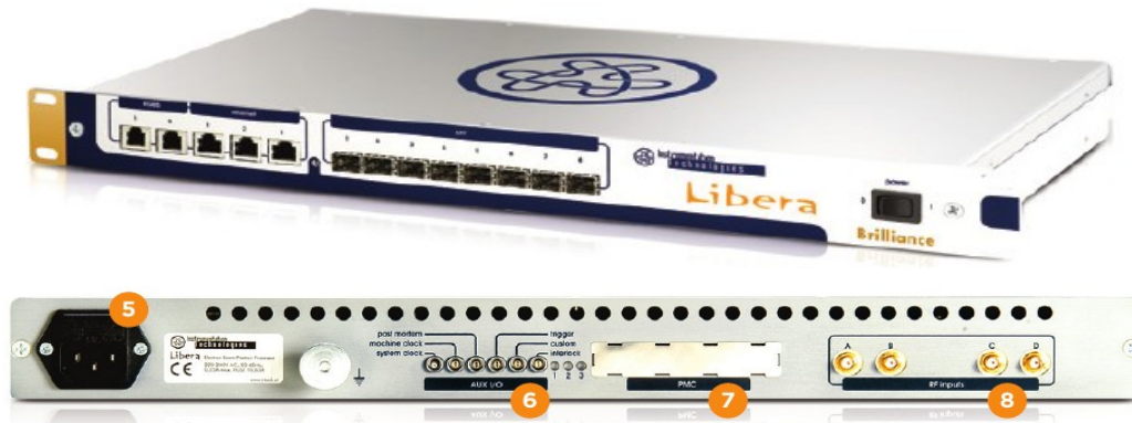
Il·lustració 2.3: Libera BPM. A dalt, la part frontal. A baix, la part posterior.
