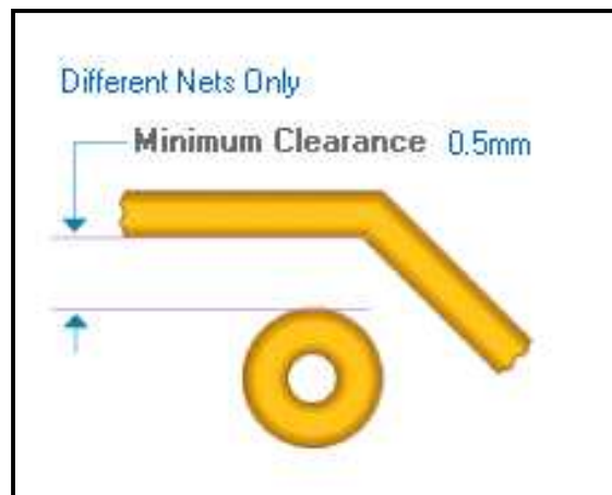
Fig. 7.52. Distància entre pistes
