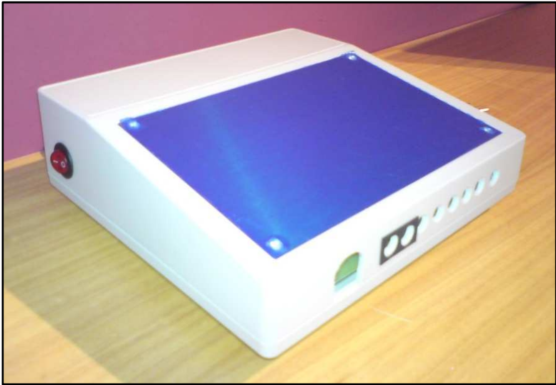
Fig. 7.68. Encapsulat regulador de llum controlat per ordinador
