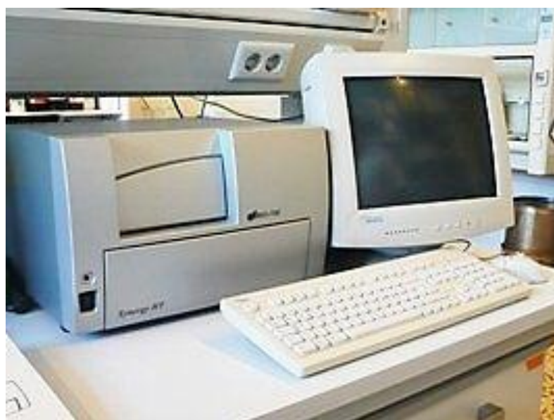
Lector d'absorbància "Epoch BioTek" treballant amb plaques microtiter
