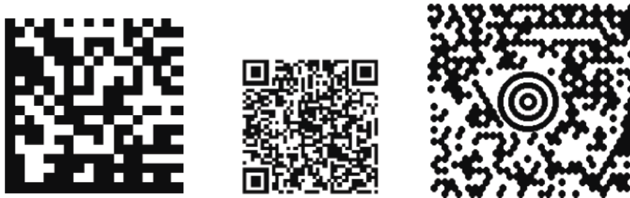
Fig. 8.1.2 Exemples codificacions DataMatrix, QR i MaxiCode, respectivament.
