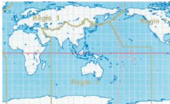
Fig. 7.4.8 Distribució de regions per assignació de freqüències, article RFID: La tecnología de identificación por radiofrecuencia (Universidad Pontificia Comillas de Madrid).
