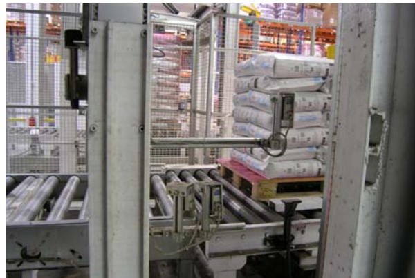
Fig. 9.3.7 Secció dels sensors d'alçada dels pallets.
