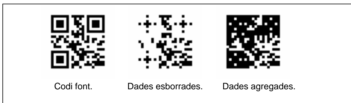
Fig. 6.4.7 Manipulació de la distorsió per part del codi QR.
