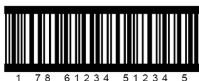
Fig. 5.3.13 Símbol ITF 14 amb barres superior i inferior al marc d'impressió.
