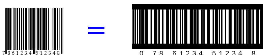
Fig. 5.3.12 El mateix codi EAN 13 representat mitjançant EAN 13 i ITF 14
