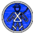
PROTECCIÓN INDIVIDUAL OBLIGATORIA CONTRA CAÍDAS
