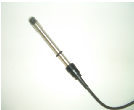
Figura 5.8. Sondes d'oxigen dissolt
