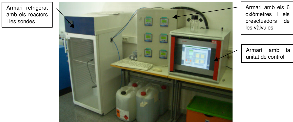
Figura 5.2.- Respiròmetres i unitat de control
