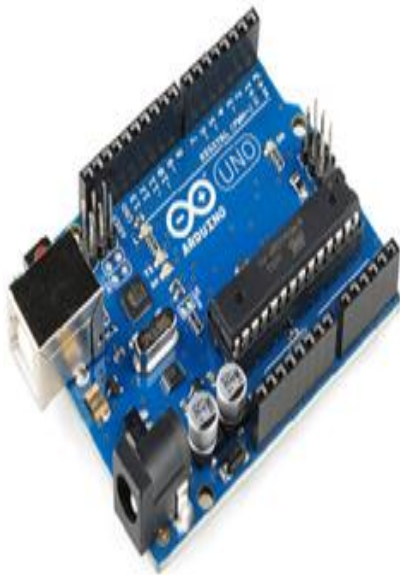
Il·lustració 3.1.2.1 placa Arduino Uno
