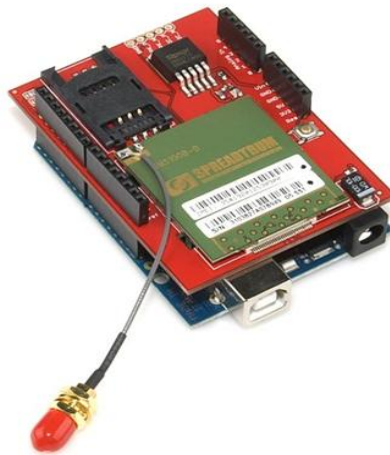
Il·lustració 4.3.4 ARDUINO SHIELD GSM-GPRS SPARKFUN AMB SM5100B.
