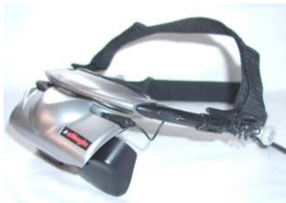
Figura 10. Un HMD amb les dues pantalles davant de cada ull (Font Wikipèdia)
