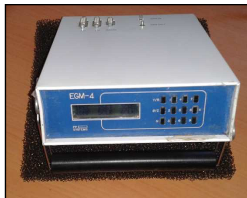
Figura 5. Analizador de gases modelo EGM-4
