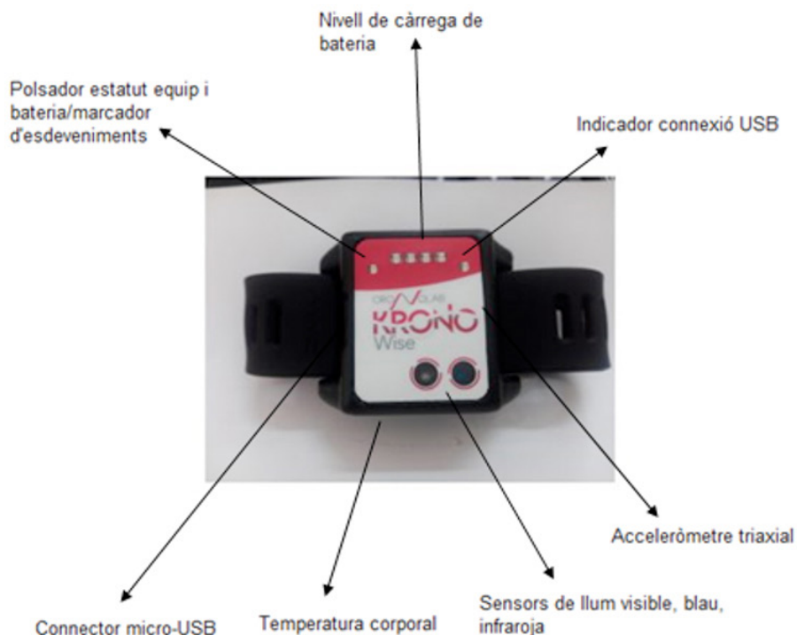
Figura 31: Exemple de sensor Kronowise que es va utilitzar per a la investigació i la recollida de dades de salut circadiària de les participants
