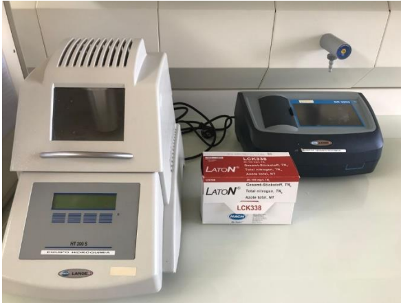
Figura 13. Termòstat HT200S per digerir les mostres a alta velocitat, kit LCK 338, espectrofotòmetre DR 3900 Lange Hach.
