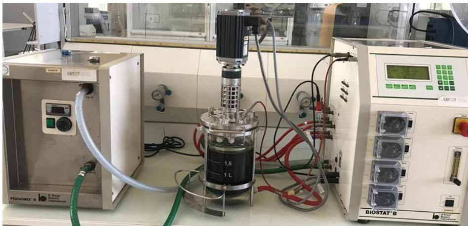
Figura 32. Escalat del procés en un fermentador biològic Braun Biotech Biostat B de 2L.
