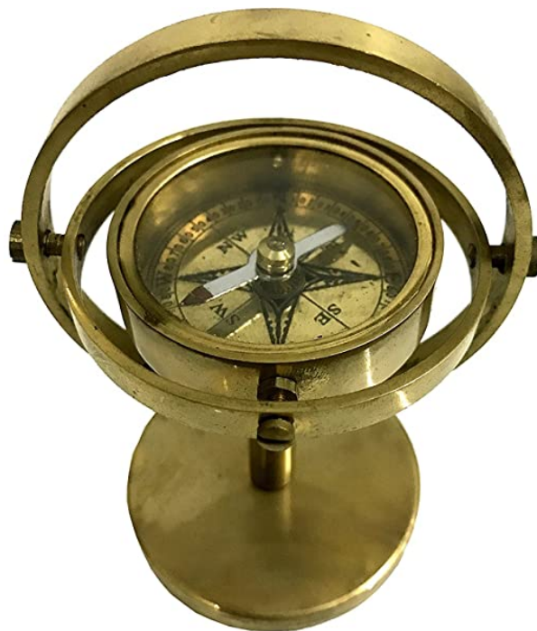
Figura 1.1: Giroscopi d'anells estabilitzant una brúixola Font: https://bit.ly/giroscopi
