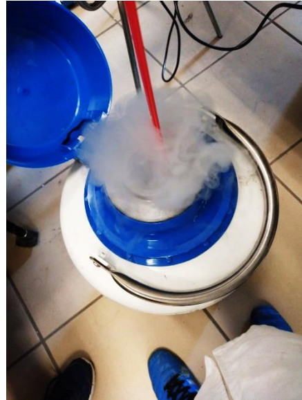
Fig. 32 Almacenamiento de muestras en nitrógeno líquido (a -196\text{ }^{\circ}\text{C} ) contenido en cántara de seguridad especial. Fuente: propia.
