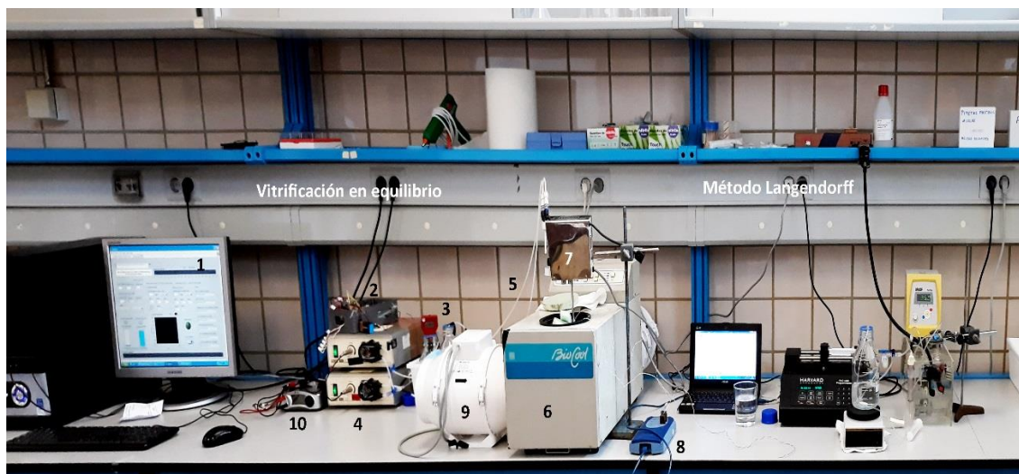
Fig. 31 Espacio donde se lleva a cabo el procedimiento de vitrificación en equilibrio (izquierda) y método Langendorff (derecha). 1/ Ordenador desde donde se controla el movimiento de las bombas peristálticas. 2/ Placa conectada al ordenador y bombas para traducir la señal del ordenador. 3/ Depósitos de DMSO y PBS. 4/ Bombas peristálticas. 5/ Tubos del sistema hidráulico. 6/ BioCool. 7/ Agitador. 8/ Picolog y termopares. 9/ Ventilador. 10/ Voltímetro. Fuente: propia.
