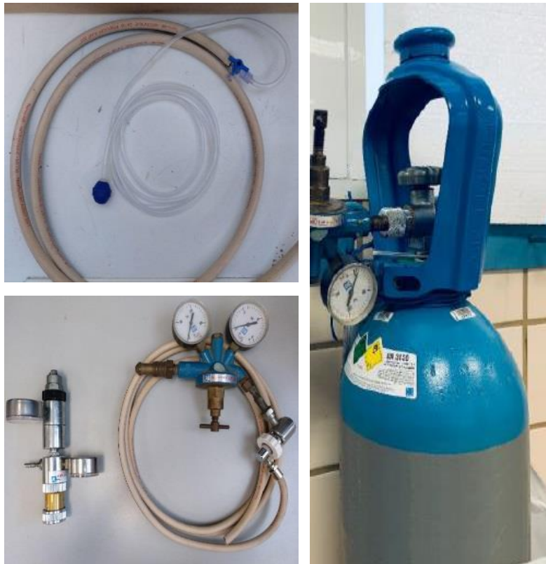
Fig. 56 Tubo del circuito de carbógeno (superior izquierda). Tubo de circuito de carbógeno junto con manorreductores (inferior izquierda). Bombona de carbógeno (derecha). Fuente: propia.
