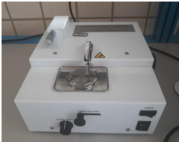
Fig. 74 Equipo Chopper para el corte de rodajas de encéfalo, proporcionado por el IBIS. Fuente: propia.
