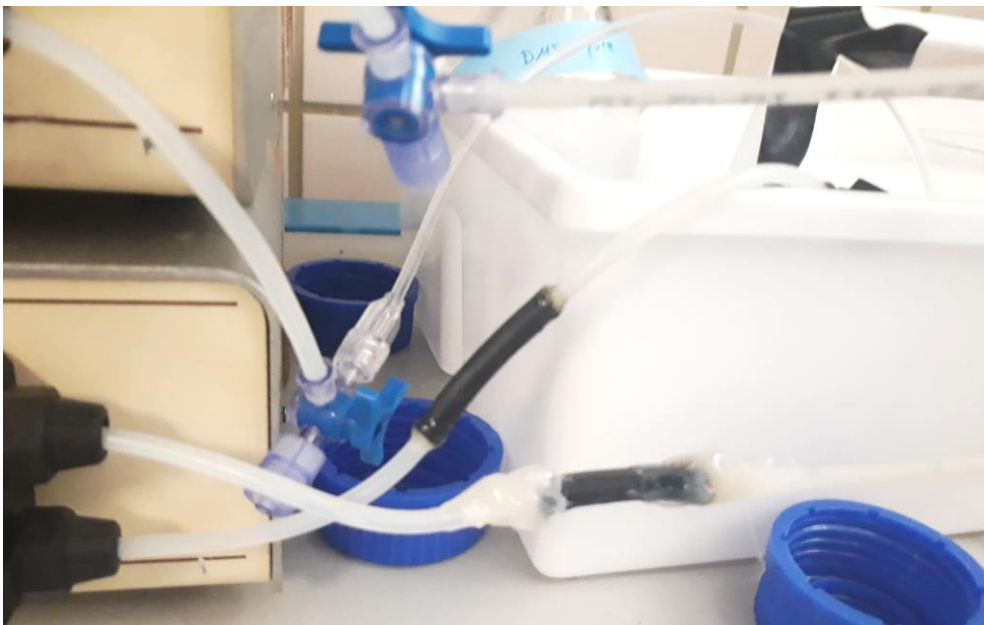
Fig. 52 Baipás entre tubos de silicona mediante tubo de polietileno de mayor diámetro (negro), con las conexiones selladas con silicona. Fuente: propia.
