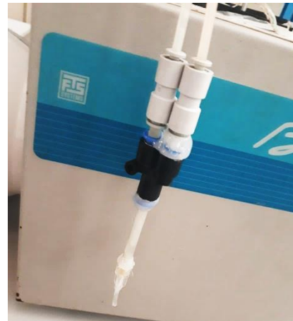
Fig. 30 Conexión en forma de T del sistema hidráulico de vitrificación. Las sustancias a velocidades determinadas que avanzan por los tubos paralelos se mezclan al llegar al punto de unión. Fuente: propia.
