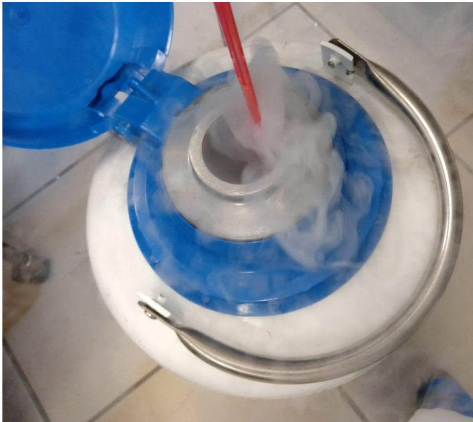
Fig. 60 Cántara de seguridad de contención de nitrógeno líquido. Fuente: propia.
