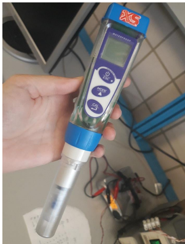
Fig. 55 Multiparamétrico utilizado esencialmente para medir el pH y la temperatura. Fuente: propia.
