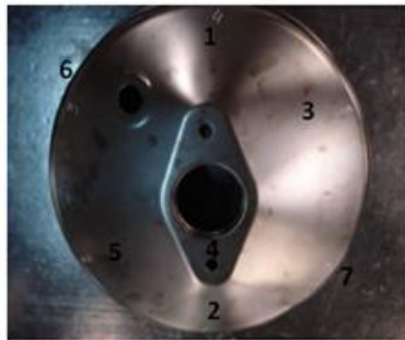
Fotografia 3.10: Puntos medida espesor
