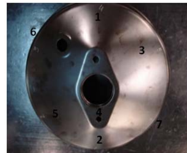
Fotografía 3.14: Puntos medida espesor.
