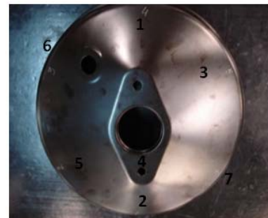
Fotografía 3.13: Puntos medida espesor
