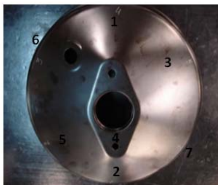
Fotografía 3.17: Puntos medida espesor.
