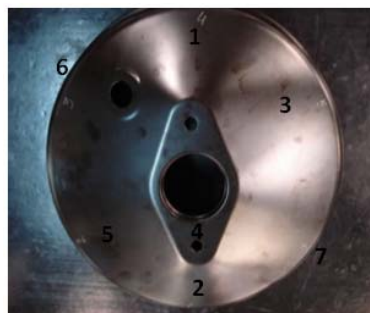
Fotografía 3.9: Puntos medida de espesor.
