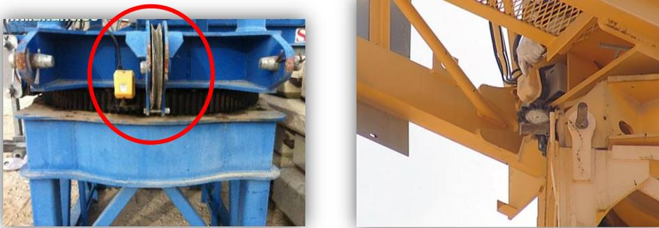
Fig. 6.; Posición del limitador de orientación.
