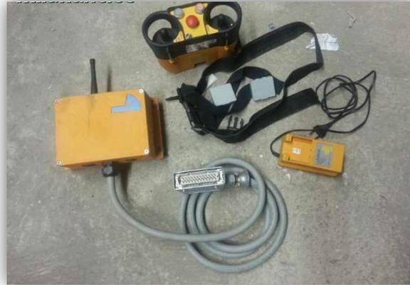
Fig. 9.; Equipo de control de la grúa (equipo de radiofrecuencia, control de mando etc.)
