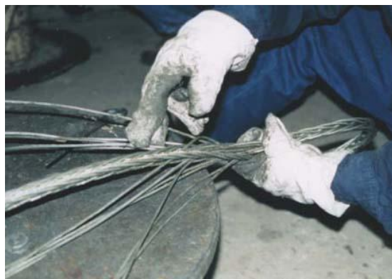
Fig. 1. Composición de un cable metálico
