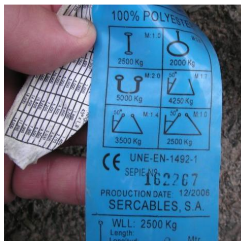
Fig. 27. Ejemplo de un etiquetaje de una eslinga de poliéster.
