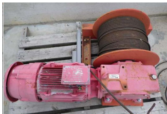
Fig. 32. Motor / reductor / tambor
