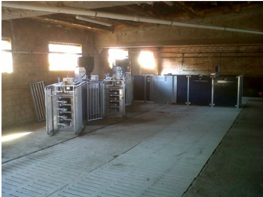
Foto 21: Detall de les dues màquines d'alimentació electrònica instal·lades amb la unitat separadora al fons. Tot a punt per a començar-hi a entrar truges.
